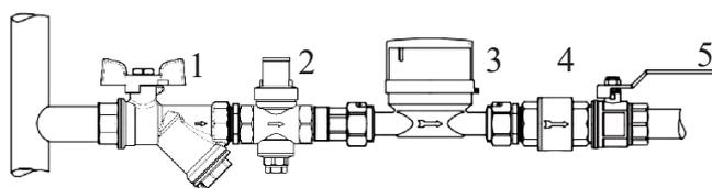
После монтажа система должна быть подвергнута гидравлическому испытанию статическим давлением, в 1,5 раза превышающим рабочее, но не менее 6 бар. Гидравлическое испытание проводится в соответствии с процедурой, описанной в СП73.13330.2016.
